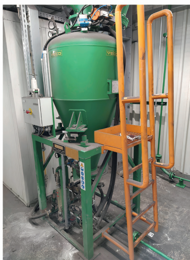
Bild 3: Automatisierte Einblasanlage zur kalkbasierten Entschwefelung, a) Anlagenlayout, b) Einblasvorrichtung, c) Einblasanlage [24]
