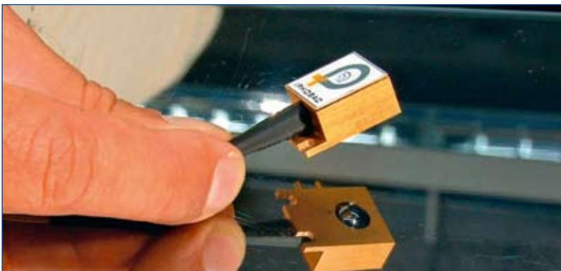
In Duisburg entwickelter 300-GHz-Transmitter mit optischer Faseranbindung und quasi-optischer Fokussierung der generierten Terahertz-Strahlung.
